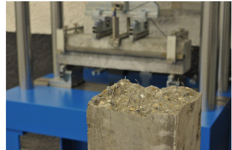
Bruchfläche Betonprisma mit Stahlfaserarmierung
