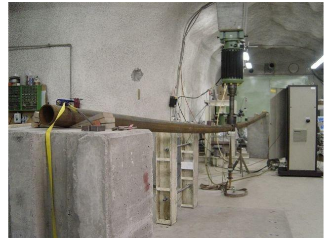
Biegezugversuch an Rohrschirm-Rohren
