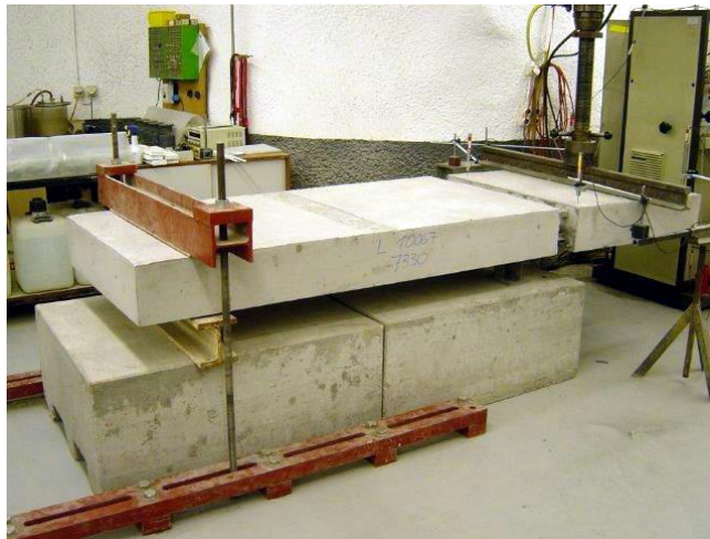
Versuchseinrichtung Element Kragplattenanschluss
