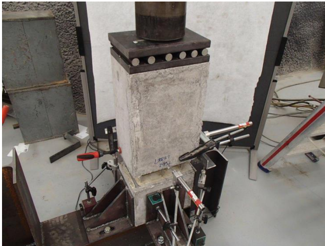
Normalkraftelement mit zentrischer Krafteinleitung (N)
