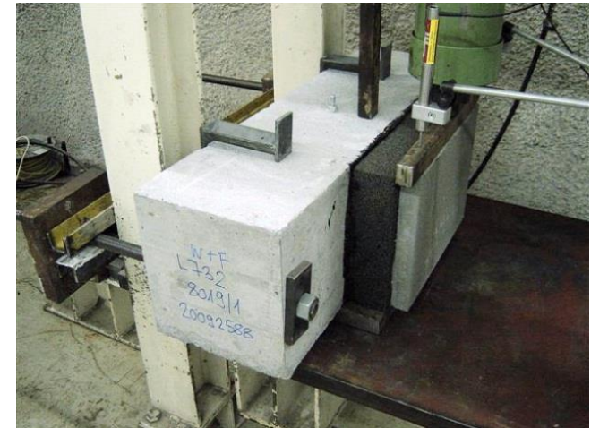
Scherversuch Isolation (Schaumglas) und Fassadenelement
