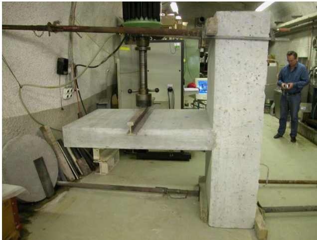
Prüfung Anschluss Geschossdecke in Wand aus Schaumglasbeton
