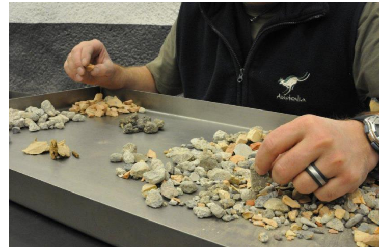
Prüfung Klassifizierung von RC-Material (stoffliche Zusammensetzung)
