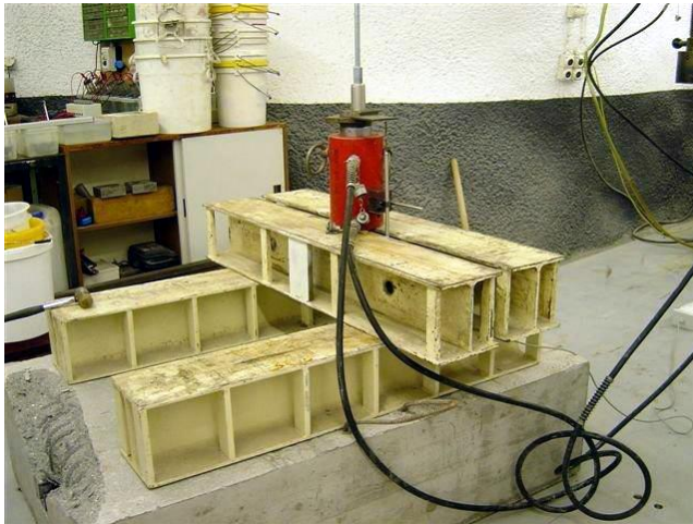
Zugversuch an Ankerschiene
