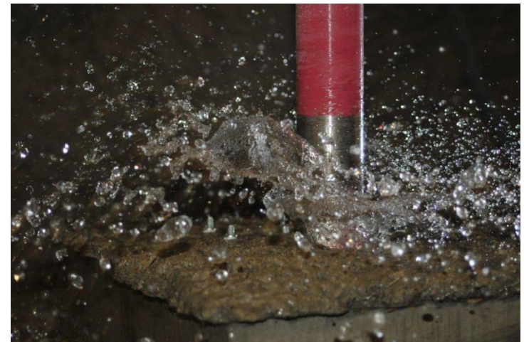
Entnahme von Bohrkern aus Spritzkiste
