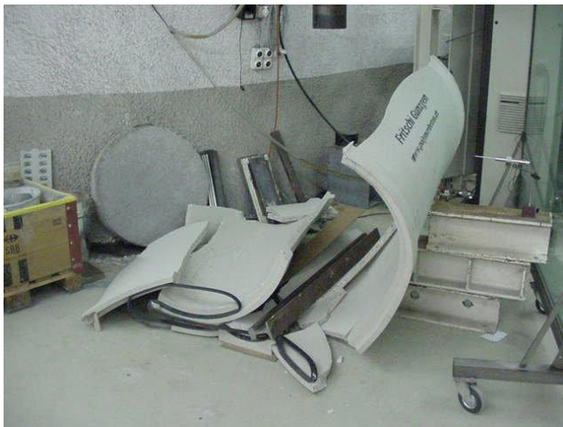
Kanalrohr nach Prüfung
