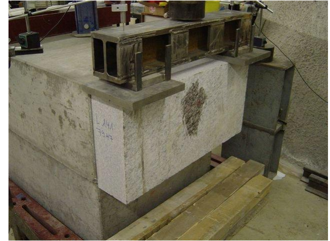
Schubversuche Granitabdeckplatten RhB
