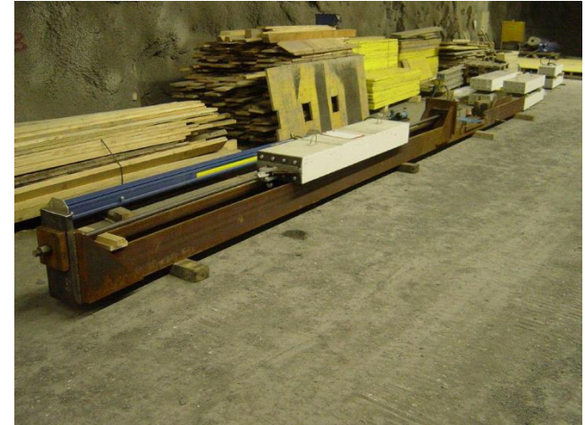
Rissinjizierung durch vorgängigen Zugversuch
