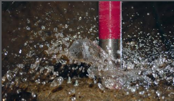
Bohrkernentnahme aus Spritzkiste
