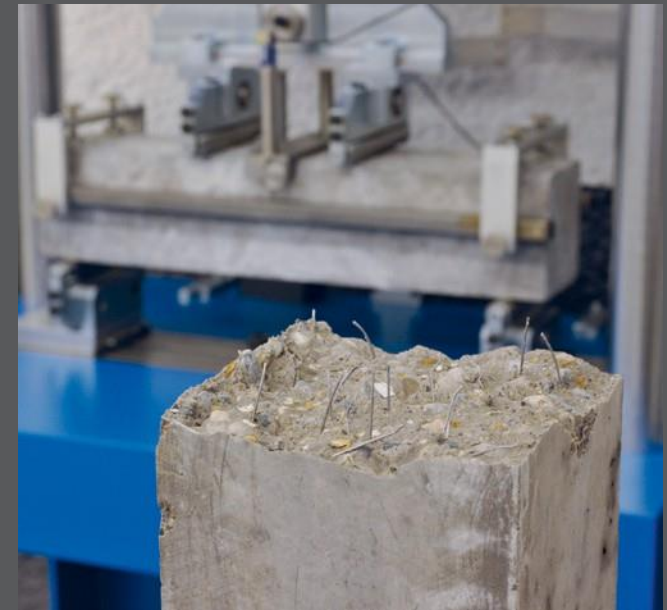
Deformationsgesteuerter Biegezugversuch an faserarmiertem Betonprisma
