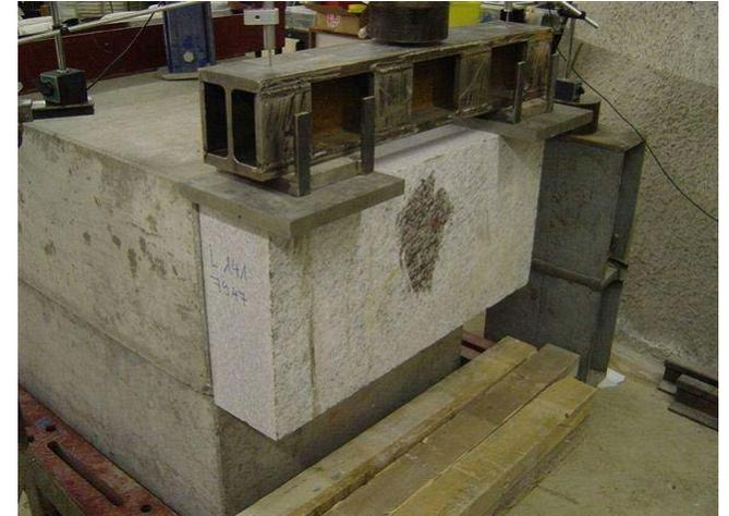
Schubversuche Granitabdeckplatten RhB
