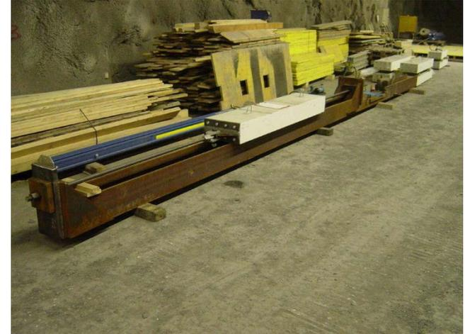
Rissinjizierung durch vorgängigen Zugversuch
