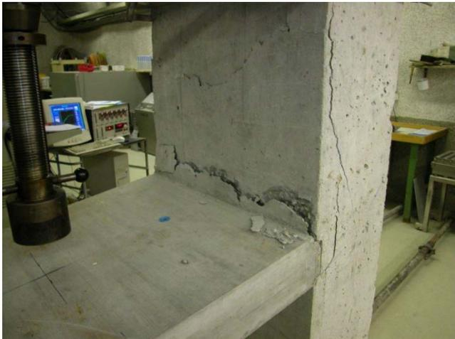
Bauteil nach der Belastungsprüfung
