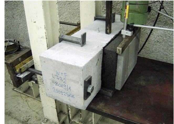
Scherversuch Isolation (Schaumglas) und Fassadenelement
