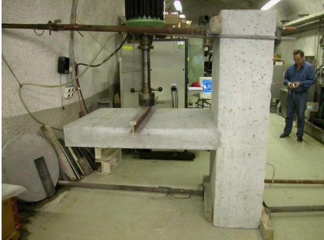
Prüfung Anschluss Geschossdecke in Wand aus Schaumglasbeton
