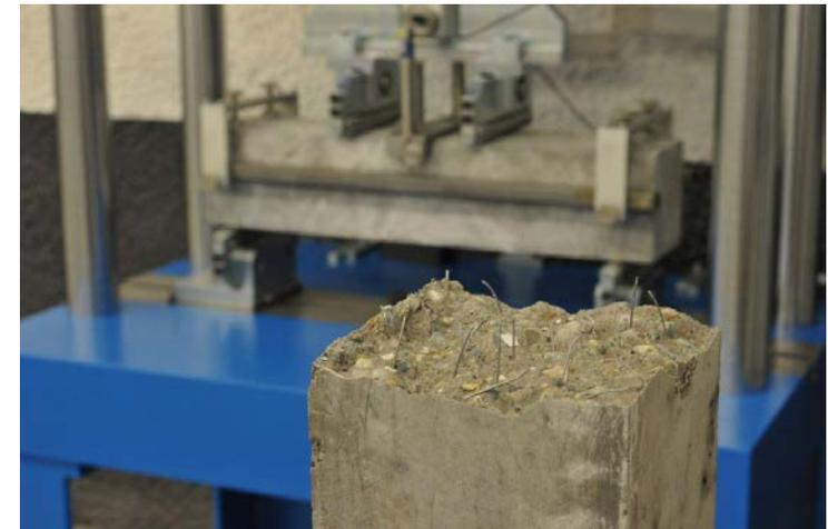
Bruchfläche Betonprisma mit Stahlfaserarmierung
