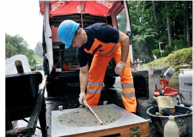
Prüfung Konsistenz (Ausbreitmass)
