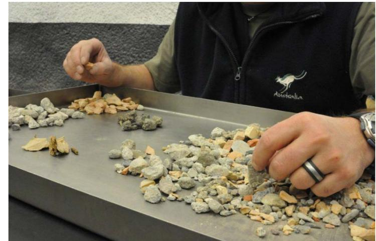
Prüfung Klassifizierung von RC-Material (stoffliche Zusammensetzung)
