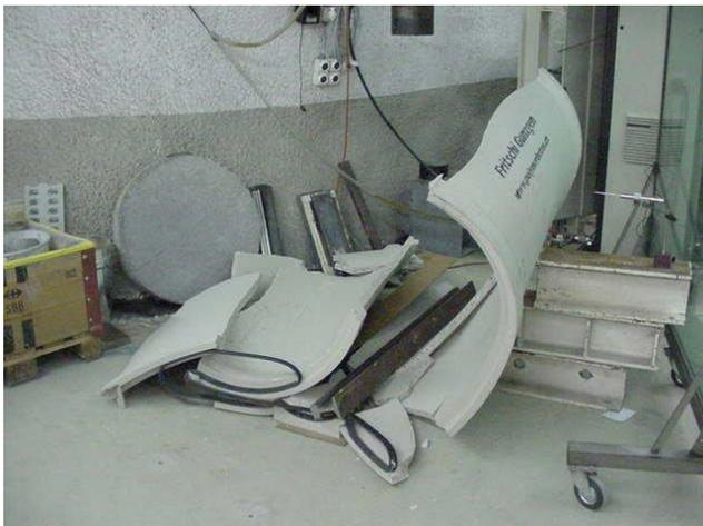
Kanalrohr nach Prüfung
