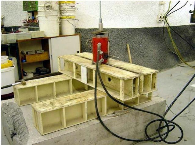
Zugversuch an Ankerschiene
