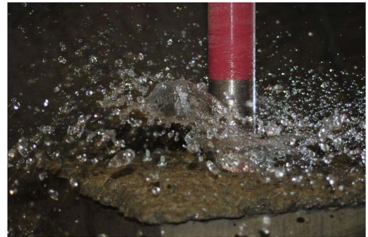
Entnahme von Bohrkern aus Spritzkiste
