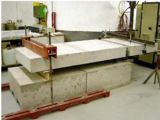
Versuchseinrichtung Element Kragplattenanschluss
