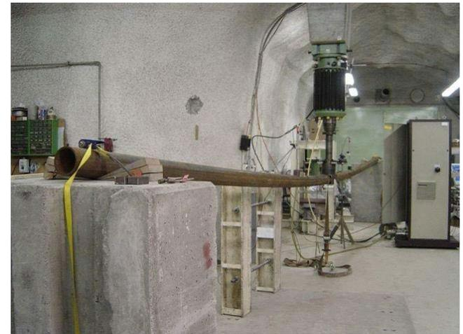
Biegezugversuch an Rohrschirm-Rohren
