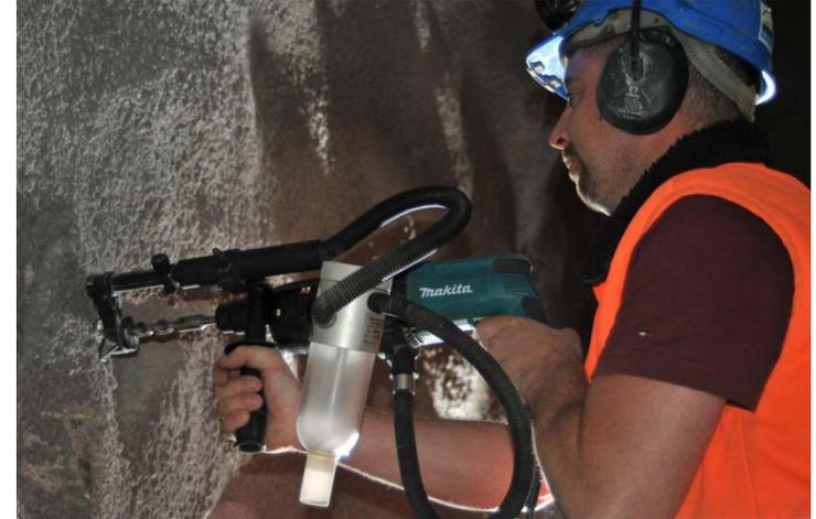
Entnahme von Bohrmehl
