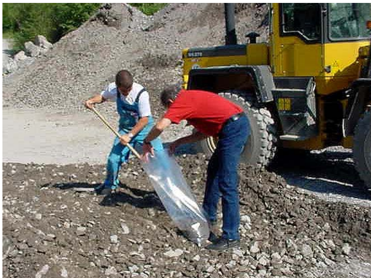
Probeentnahme von Gesteinskörnungen
