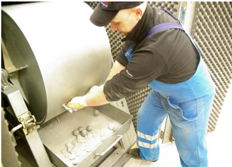
Widerstand gegen Zertrümmerung, Los Angeles Versuch
