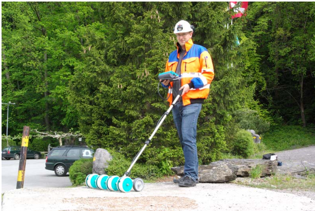
Durchführung der Potentialfeldmessung mit 4-Radelektrode
