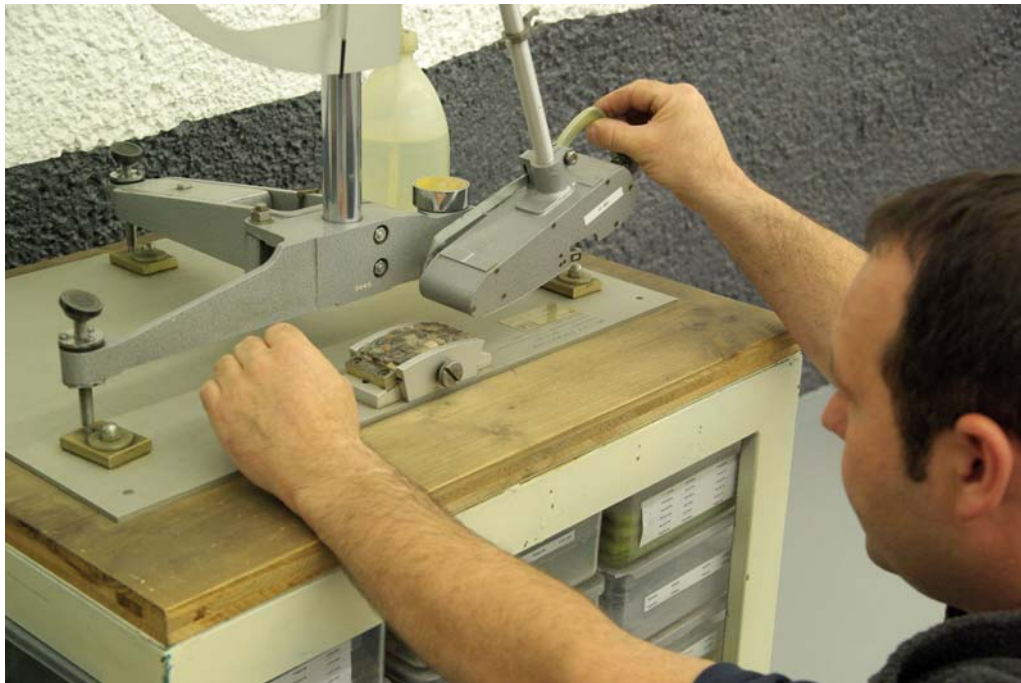
Bestimmung des Polierwiderstandes PSV (Ermittlung der verbliebenen Griffigkeit)
