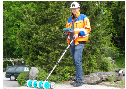
Potentialmessung mit dem CANIN+ 4-Radelektrodensystem
