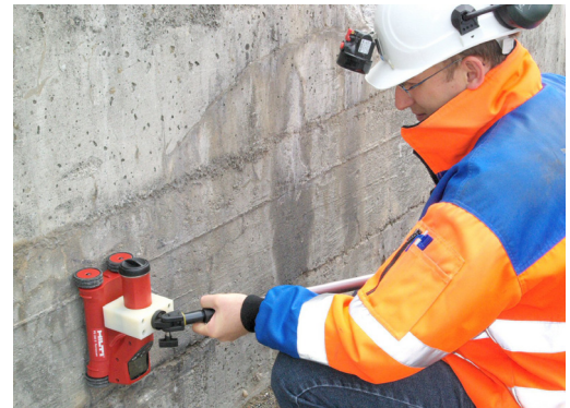
Armierungsortung mit dem «Ferroscope System PS 200»
